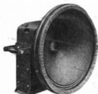
Telefunken Riesenkraft I Ela L 411 Höchster Wirkungsgrad mit Nawi- Membran. Maximale Belastung 70 Watt. Leistungsaufnahme der Feldspule 40 Watt. Anschluß- spannung 220V. Der eingeb. Ueber- trager ist an 140 Ohm angepaßt. Höhe 49,5 cm, Breite 48 cm, Tiefe 35,5 cm. Gew. etwa 60 kg, RM 750.— Gleichrichter Ela B 8:2 RM 130.— Gleichrichterröhre 4004 RM 20.—
