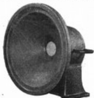
Telefunken Riesenkraft II Ela L 414 Maximale Belastung 150 Watt. Leistungsaufnahme der Feldspule 60 Watt. Anschlußspannung 220V. Der eingebaute Uebertrager ist an 140 Ohm angepaßt. Höhe 58,5 cm, Breite 57 cm Tiefe 42 cm, Gewicht etwa 77,5 kg RM 1300.— Gleichrichter Ela B 812 RM 130.— RGN 4004 . . . . . RM 20.—
